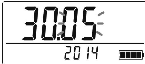
Рисунок 2.36 – РКІ дозиметра (підрежим корекції часу та дати – корекція числа та місяця)
