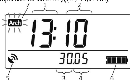
Рисунок 2.33 – РКІ дозиметра (режим відображення поточного часу)
