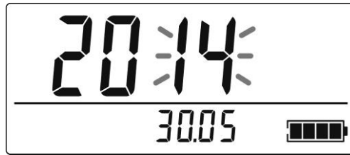
Рисунок 2.35 РКІ дозиметра (підрежим корекції часу та дати – корекція року)
