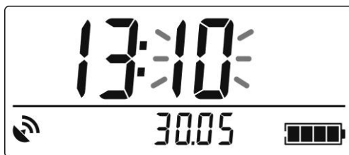
Рисунок 2.34 – РКІ дозиметра (підрежим корекції часу та дати – корекція годин та хвилин)
